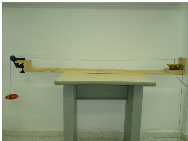
FIGURA 5. Muestra el funcionamiento del sistema generador de ondas estacionarias en cuerdas en la frecuencia fundamental.
