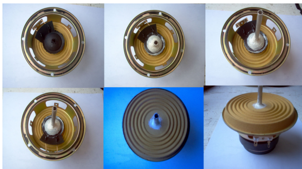
FIGURA 2. Evidencia fotográfica del proceso de construcción del generador mecánico de ondas estacionarias.
