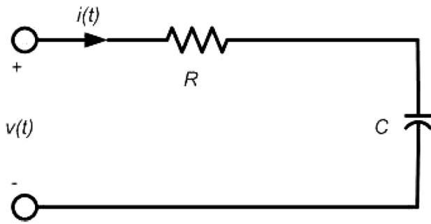
FIGURE 1. RC Circuit.
