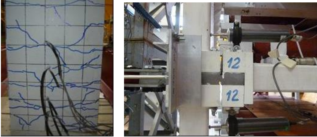
(a) Espécimen E1, daños en base de muro (grietas remarcadas) y rotaciones en fusibles después del ensaye de intensidad de diseño.
