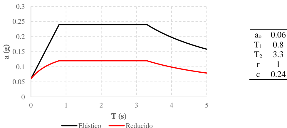
Figura 11. Espectros de diseño y parámetros correspondientes para el terreno tipo III
