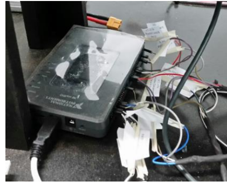
Figura 14. Tarjeta de adquisición de datos NI myRIO.
