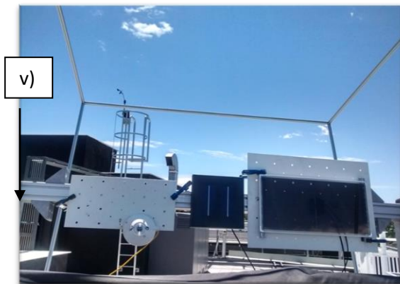
Figura 4. Montaje de instrumentos sobre el eje de la plataforma (v), al fondo se observa parte de la estructura de aluminio.
