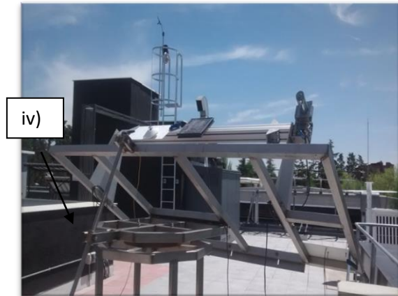
Figura 5. Plataforma giratoria para sujeción de los módulos a ensayar. iv) Se observa el mecanismo mediante un tornillo y una manivela para orientar los módulos hacia el sol de manera correcta.
