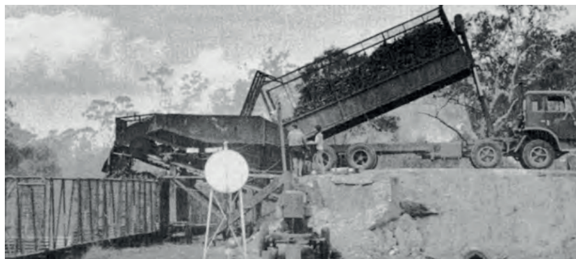
Figura 5. Camión de volteo con sistema hidráulico de descarga trasera (Australia)
