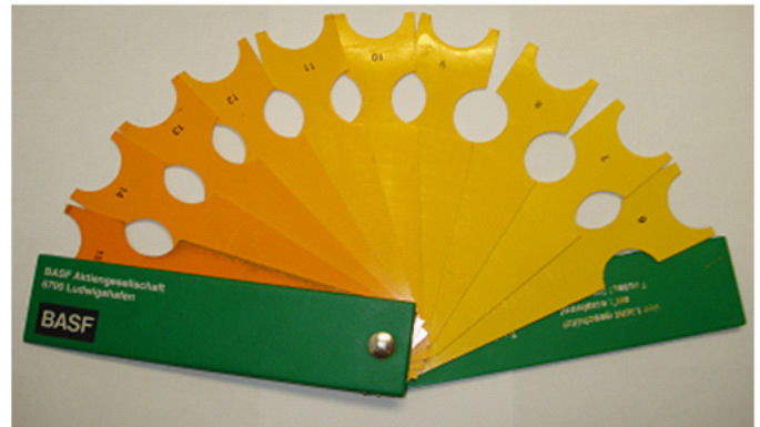
Figura 1. Abanico Roche utilizado en la medición de la intensidad de color amarillo de la yema de huevos producidos en dos sistemas de producción.
