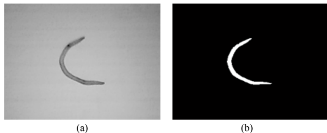
Figura 4. Posterización de imágenes: a) nivel de grises con resolución de 8 bits; y b) blanco y negro.
