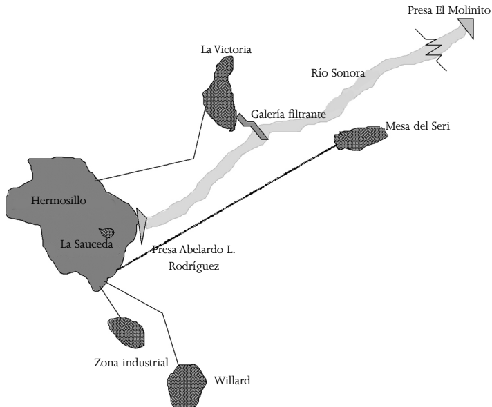
Figura 4 Sistema de suministro de agua a Hermosillo
