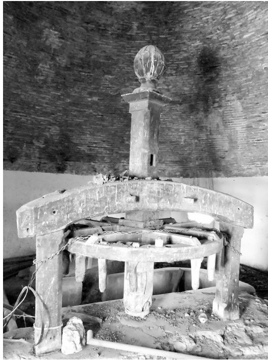
FOTOGRAFÍA 8. COMPONENTES DEL EJE VERTICAL (NORIA DE PROVIDENCIA) QUE MUESTRA LA RUEDA DE AIRE, EL EJE DE GIRO, EL TRAVESAÑO O PUENTE Y LAS VIGAS DE SOPORTE DEL PUENTE
