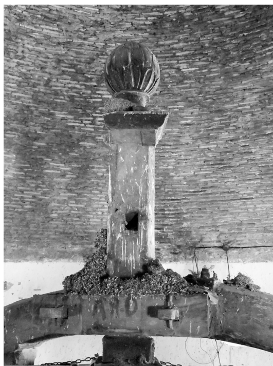
FOTOGRAFÍA 9. DETALLE DEL EJE VERTICAL O EJE DE GIRO (NORIA DE PROVIDENCIA) QUE MUESTRA LA FORMA DE SUJECIÓN AL TRAVESAÑO O PUENTE Y EL ORIFICIO PARA INSERTAR UNO DE LOS VARALES
