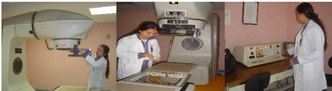
FIGURA 2. Unidad de Cobalto 60 (Theraton 780E), del Centro Estatal de Cancerología de Xalapa, Veracruz, utilizada para la irradiación de semillas de Abies religiosa (Kunth) Schltd. et Cham.
