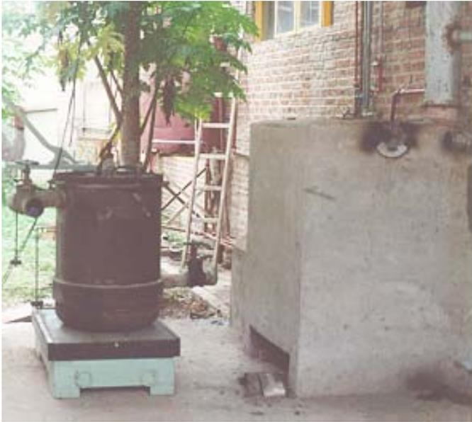
FIGURA 1. Retorta vertical y horno de calefacción utilizada en el proceso de destilación seca.
