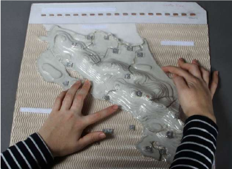
Figuras 9. Matriz producida artesanalmente correspondiente al mapa físico de Costa Rica y copia en plástico transparente, termoformado. Fuente: CECAT-UTEM.
