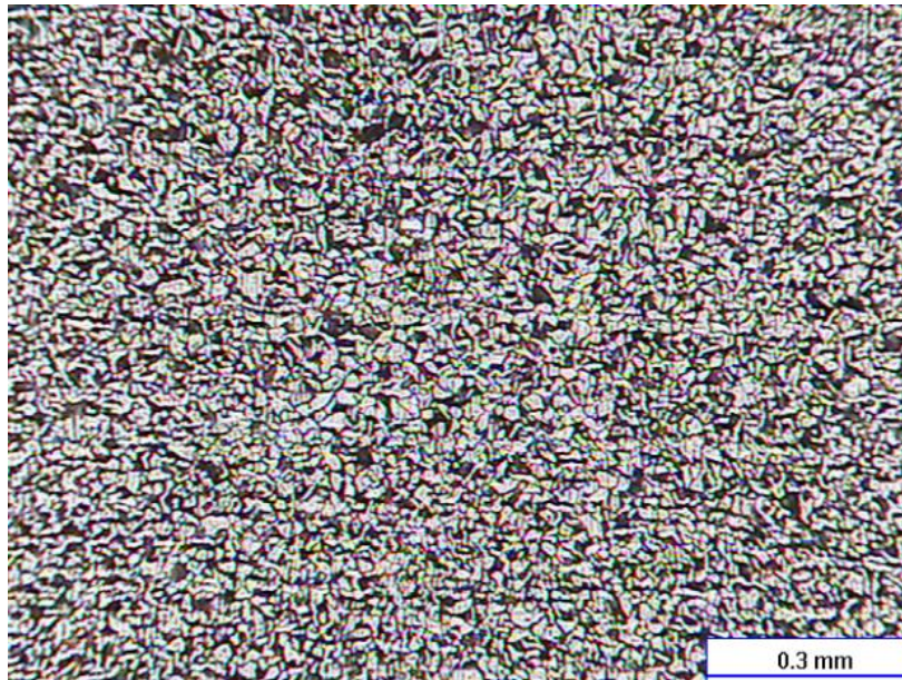
Figura 4. Microestrutura do aço carbono a 100X.
