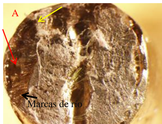
Figura 11A. Fratura da amostra com bisel individual com terceiro Inconel. Observa-se falta de fusão (seta vermelha) e cavidades (seta amarela) na fratura.
