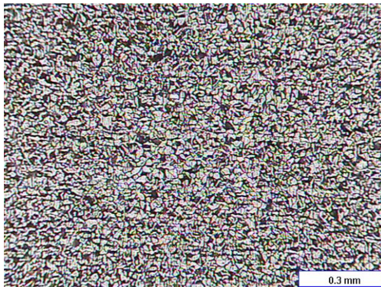
Figura 4. Microestructura del acero al carbono a100X.
