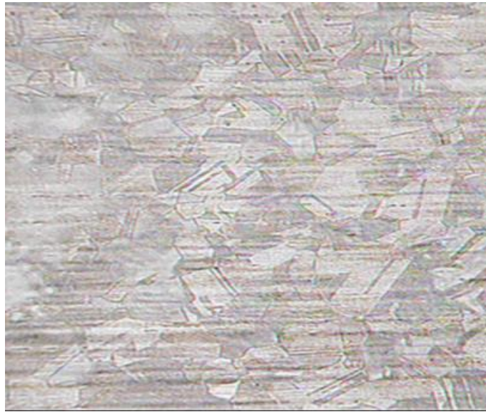
Figura 5. Microestructura del acero inoxidable AISI 304 a 100X.
