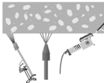
Figura 16b. Esquema de jateamento e desbaste dos cantos
