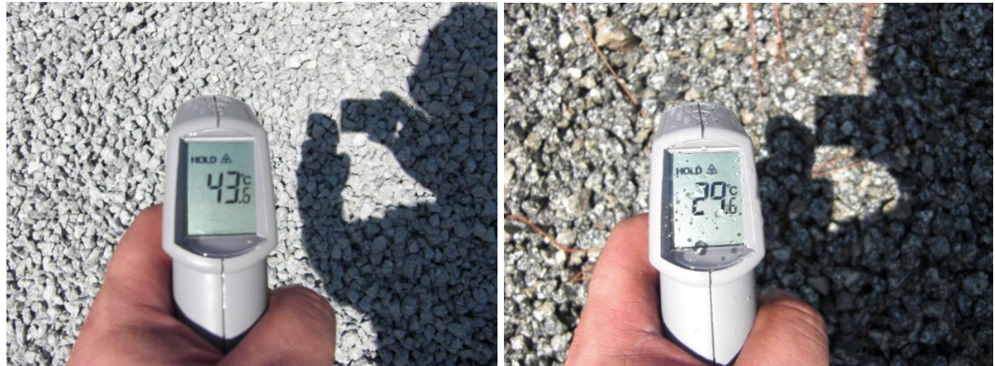
Figura 7. Registros de la temperatura del árido grueso antes y después de haber sido rociado con agua en la planta dosificadora de la Compañía de Hormigón Premezclado.
