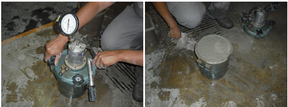
Figura 3. Medidas del contenido de aire incluido (atrapado) y de la densidad aparente.
