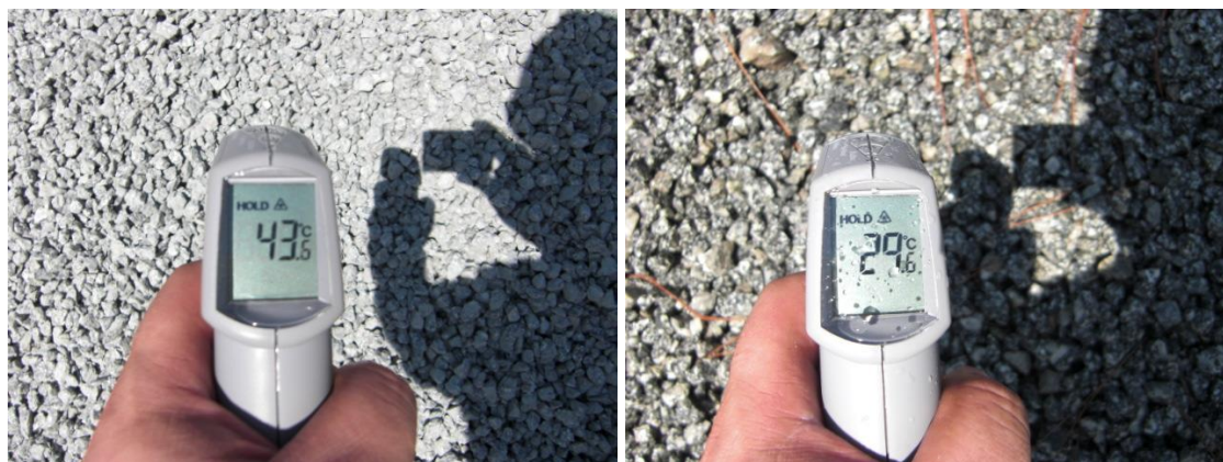
Figura 7. Registro da temperatura dos agregados graúdos antes e após a aspersão de água na central de concreto.
