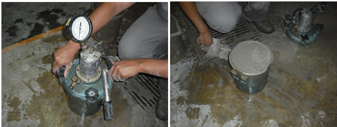
Figura 3. Aferição do ar aprisionado e da massa específica.
