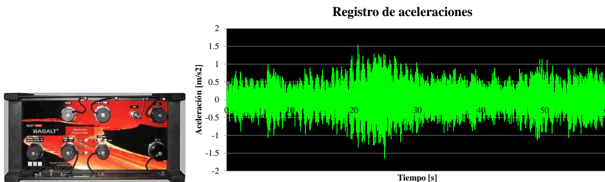
Figura 7. Acelerómetro digital Basalt (Kinometrics) y un registro de aceleraciones.
