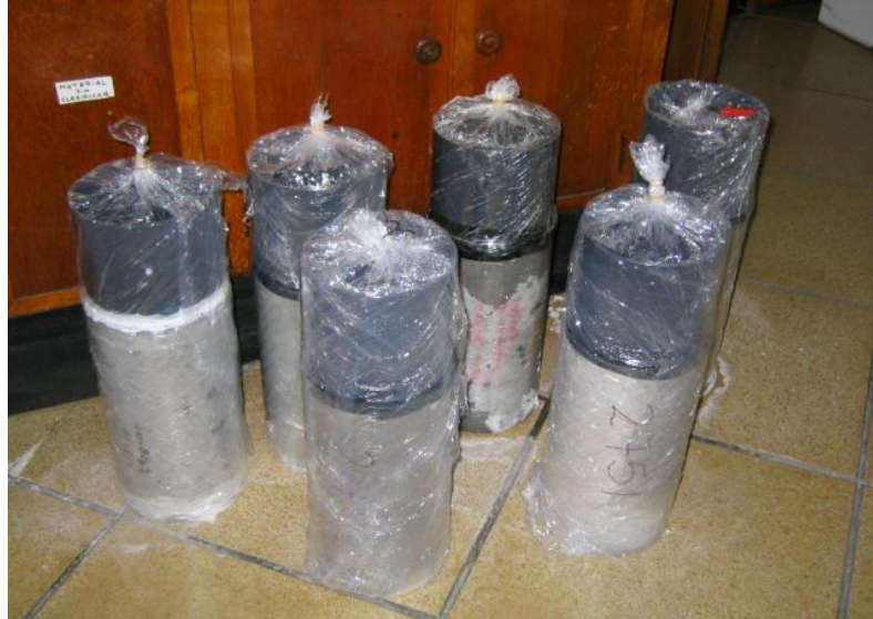
Figura 3. Ensayo natural de difusión de cloruros.
