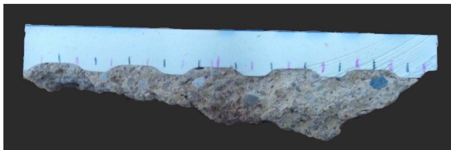
Figura 4. Seção plana da amostra com argamassa aderida ao tardo do azulejo para análise da extensão de aderência.
