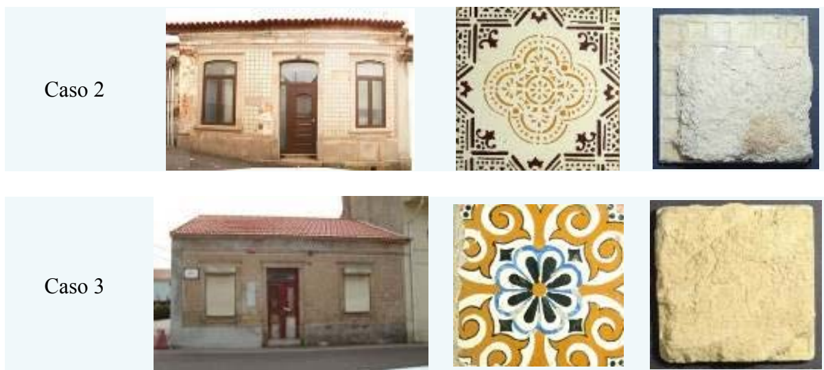
Figura 2. Fachada, detalhe do azulejo e amostras de argamassas de assentamento aderidas no tardo das placas dos três casos analisados.
