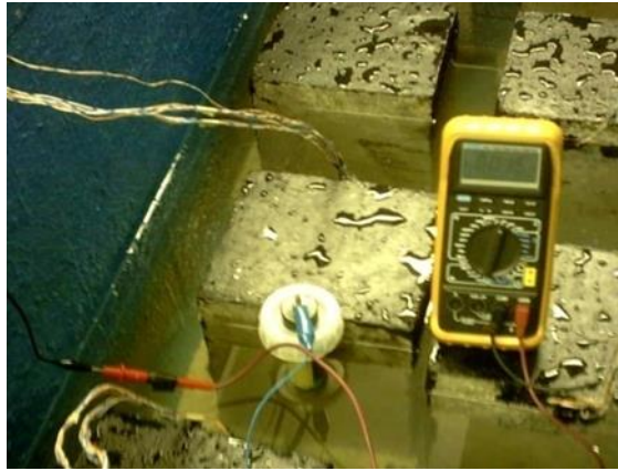
Figura 4. Monitoramento com multímetro e eletrodo de referência Cu/CuSO 4
