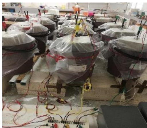
Figura 2. Montaje experimental usado para la realcalinización electroquímica.
