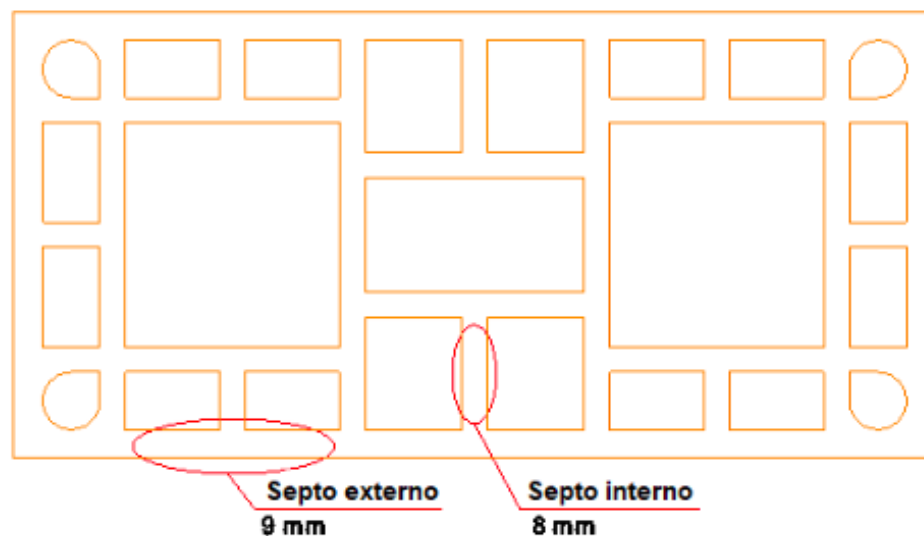
Figura 8. Paredes internas e externas dos blocos.
