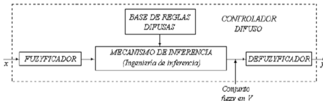
Fig. 3. Componentes de una Máquina de inferencia Difusa
