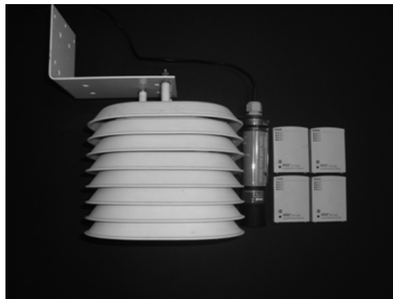
Figura 13. Equipo de medicion de temperaturas, fuente: tomado de (ONSET, 2014, p. 11)
