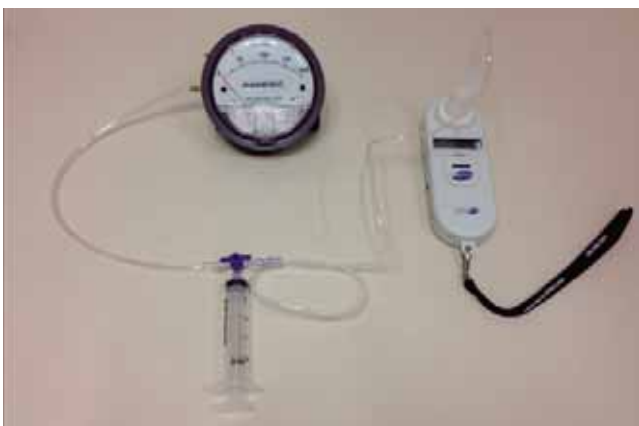
Figura 4. Calibración de presión de equipo portátil.
