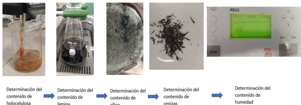
Figura 1. Procedimiento llevado a cabo en el Dpto. DEPI del Instituto Tecnológico Zacatepec (ITZ), para caracterizar la cascarilla de arroz Var. "Morelos A-2010 con la que se obtuvo la celulosa.
