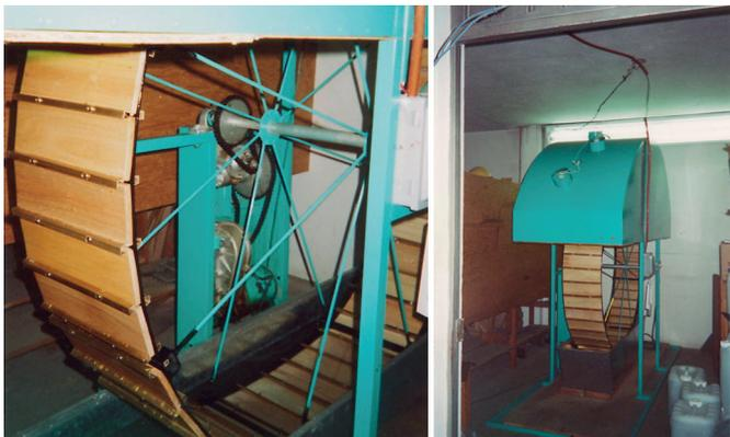
FIGURA 1. Probetas colocadas en el equipo de intemperismo acelerado. Rueda de degradación utilizada por el Centro Técnico de la Madera y del Mueble de Francia (adaptada de Podgorski *et al.*, 1996). Readaptada para esta investigación.
