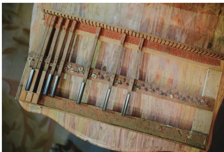
FIGURA 5. Teclado del clavecín MCB, fuera del instrumento (Fotografía: Ramsés Juárez, 2020; cortesía: Museo Casa de la Bola, Colección de la Fundación Cultural Antonio Haghenbeck y de la Lama IAP, 2023).
