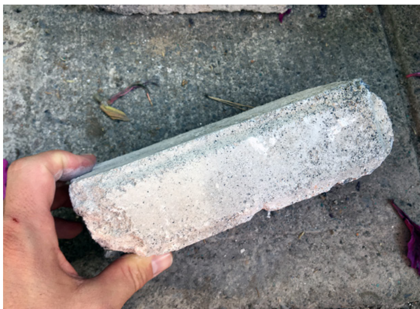
FIGURA 3. Muestra de un tabique de cemento (20 x 10 x 6 cm) liso y con bisel, extraída de la fachada de la casa ubicada en Pomona núm. 38, col. Roma Norte, en 2020 (Fotografía: Alejandro Leal y Alberto Muciño, 2020; fuente: colección de los autores).
