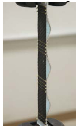
Figura 3-3. Unión biestable hecha de materiales compuestos híbridos de Carbón T300/epoxi y Spectra 900®. [4]
