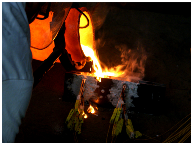
Fig. 2. Proceso de vaciado en el molde para planchones delgados. En la parte frontal, se observan los termopares y sus conexiones con la interfaz de adquisición de datos.
