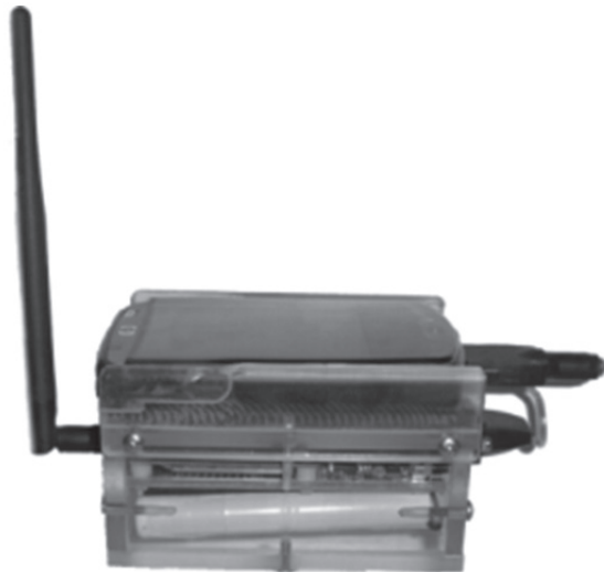
Figura 5. Panel de control: PDA y radio módem
