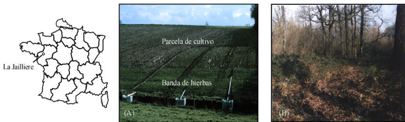
Figura 2. Dispositivos experimentales instalados en el sitio de ARVALIS de La Jaillière. (A) Barreras de hierba en la parte inferior de una parcela de cultivo. (B) Zona arbolada.
