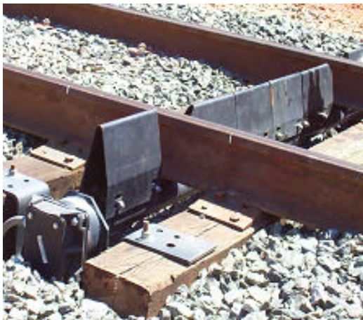
Figura 2. Detector de aparejos caídos
