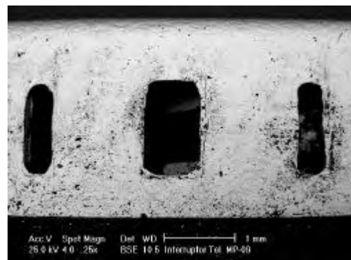
Figura 10. Interruptor. Se trata de una lámina de acero de bajo carbono troquelada y niquelada. La formación de depósitos también en este caso es mínima
