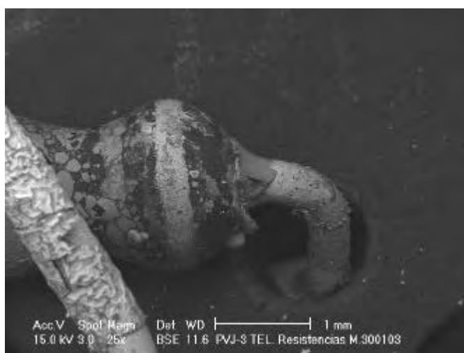
Figura 21. Conector de una resistencia. Se trata de un conductor de cobre recubierto con estaño. Los contaminantes presentes (cloruros) en combinación con una elevada humedad relativa dan como consecuencia un rápido deterioro del recubrimiento y su desprendimiento del conductor
