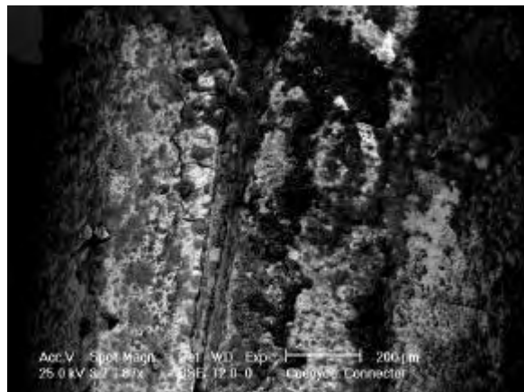
Figura 12. Conector de latón en contacto con un alambre recubierto con oro. En general, la superficie se ve deteriorada por efecto de la corrosión (zonas oscuras). Los productos de corrosión se caracterizan por la presencia de cloro, y en menor proporción azufre
