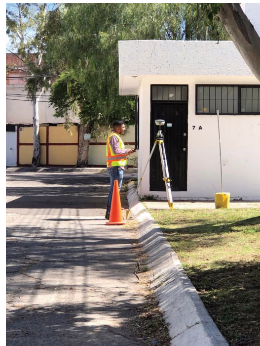
Figura 8. Medición de GCP en la colonia “El Ensueño” con el GPS Sokkia GRX2
