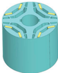
Figura 7. Modelo del rotor optimizado para el estudio
