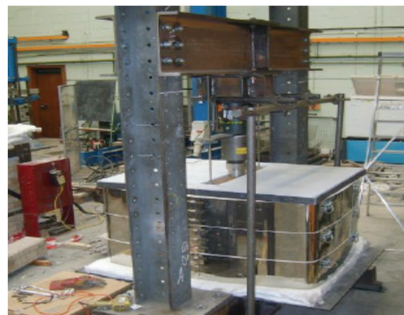
Figura 7. Equipo de prueba de carga y temperatura (marco, celda y horno), (Ruvalcaba, 2011)
