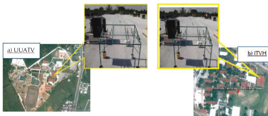
Figura 1. Panel de exposición de las muestras de acero y cobre, inclinado 45^{\circ}
