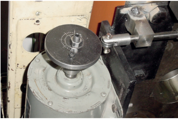
Figura 7. Mecanismo excitador de leva ajustable
