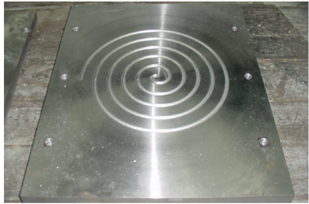
Figura 2. Molde de inyección en espiral
