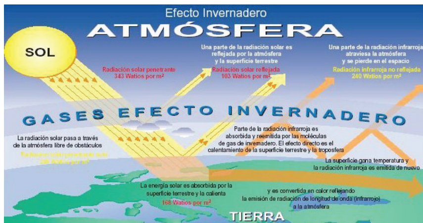
Figura 2. Esquema del efecto invernadero a escala atmosférica (UNEP-GRID-Arendal, 2007)
