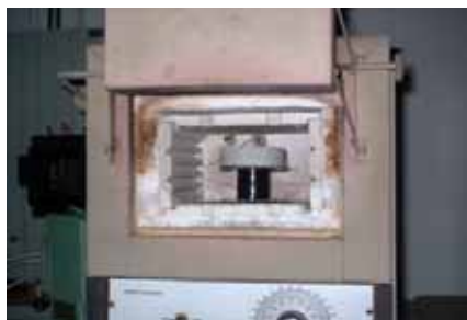
Figura 7. Prueba de temperatura para varistores fabricados con el método desarrollado
