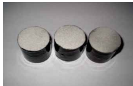
Figura 4. Varistores de \text{ZnO} con recubrimiento de resina epóxica en las caras laterales y depósito de electrodos de aluminio en ambas caras planas
