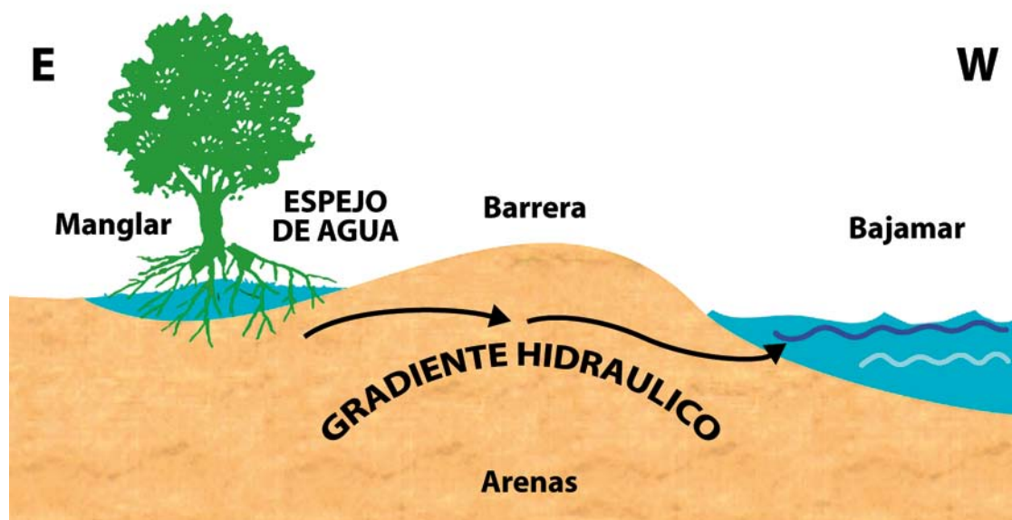
Figura 13B. Gradiente hidráulico durante la bajamar.
