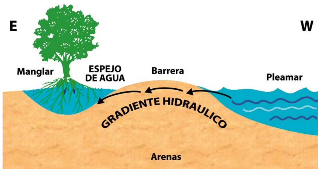
Figura 13A. Gradiente hidráulico durante la pleamar.
