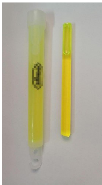
FIGURA 13. Barra de luz “glowsticks” comercial sin alterar (objeto superior) y cilindro de vidrio del compartimiento interno (objeto inferior).
