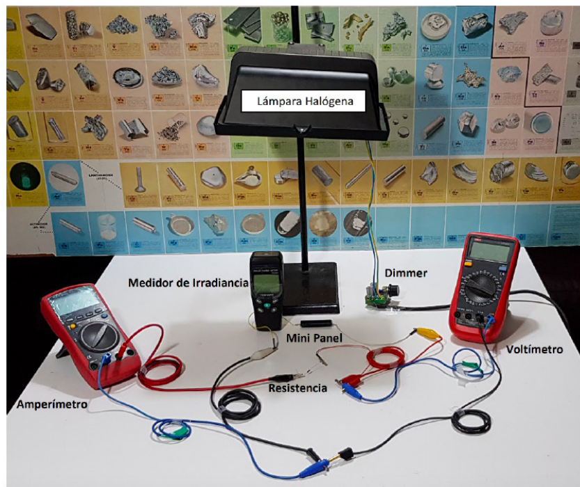
Figura 1: Sistema para determinar las curvas densidad de corriente - voltaje del mini panel solar.
