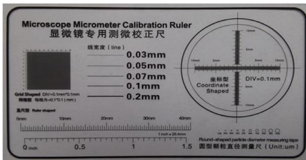
Figura 6: Regla de calibración micrométrica del microscopio digital USB FC CE RoHS de bajo costo.
