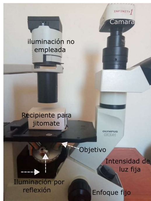
Fig. 3. Sistema de captura para imágenes del jitomate cherry en el proceso de maduración
